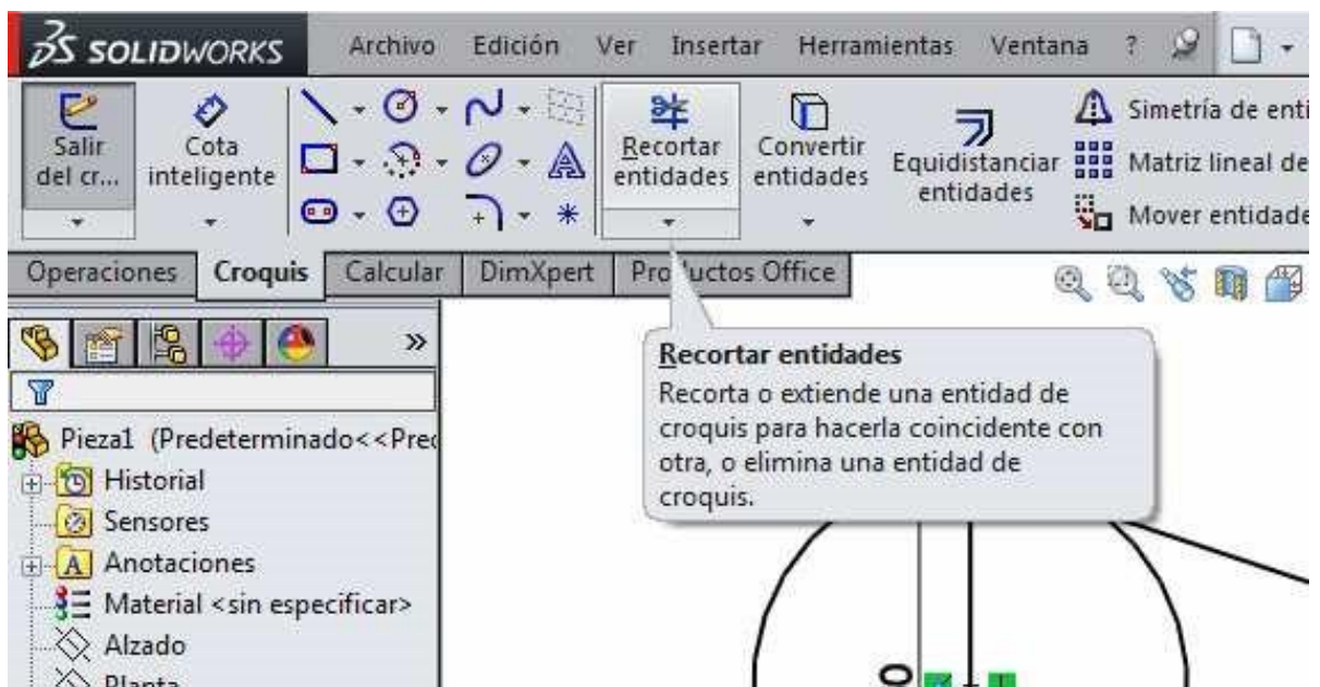
Figura 2.16. Comando para recortar líneas
